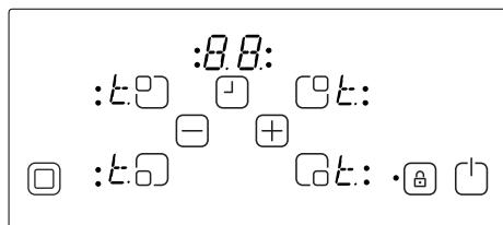
Nakon što temperatura padne slovo "t" nestat će s prikaza, dok se upravljačka ploča prebaci natrag u stanje pripravnosti. To znači da korisnik ponovno može aktivirati napravu pritiskom na .
