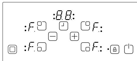
De veiligheidsuitschakeling zorgt ervoor dat de kookplaatbediening in de S-modus wordt gezet. Er zal dan een 'F' knipperen in alle pit-displays.
