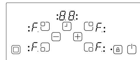
Sigurnosno isključivanje naprave uzrokuje prebacivanje upravljačke ploče u stanje pripravnosti. Na svim prikazima grijajuča treperit će slovo "F".
