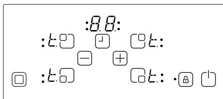
Poté, co teplota klesne, "t" zmizí a ovládání přejde zpět do režimu S. To znamená, že uživatel může spotřebič znovu zapnout, stisknutím .
