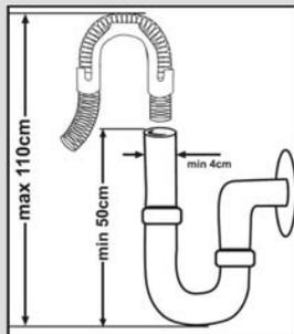
A víz kifolyótömlőt csatlakoztatni lehet közvetlenül a vízlefolyóhoz vagy a mosogatókagyló lefolyójához. Egy speciális hajlított csővel (ha rendelkezésre áll), a vizet be lehet vezetni közvetlenül a mosogatókagylóba a hajlított cső felakasztásával a kagyló szélére. A kifolyócsőnek 50 - 110 cm-re kell lennie a padló szintjétől.
