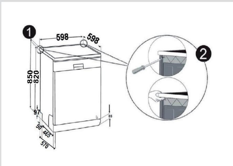
**Увага:** робоча поверхні, під якою встановлюється машина після зняття стільниці, повинна бути міцною.
