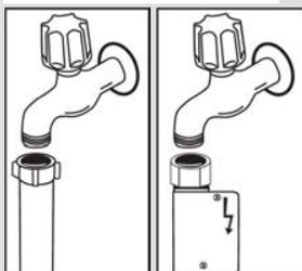
A csatlakoztatás után nyissa ki teljesen a csapot, és ellenőrizze a csatlakozás csepegésmentességét. A mosogatógép biztonsága érdekében a mosogatási programok befejezése után mindig zárja el a vízbefolyó csapot.
