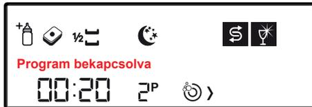
A program elindításakor láthatja a kiválasztott program nevét a Kijelző tájékoztató csíkján (21), a hátralévő mosogatási időt a Hátralévő idő kijelzőn (19) és a kiválasztott program számát a program szám kijelzőn (20).
