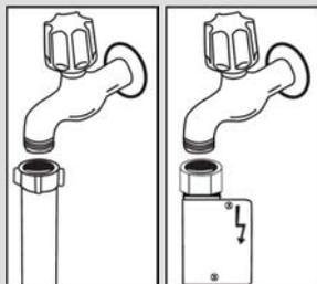
Після підключення, закрийте кран і перевірте герметичність з'єднання. Для безпечної роботи машини, закривайте кран подачі води після кожного миття.
