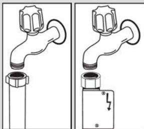
**POZNÁMKA:** V některých modelech je použito zařízení Aquastop. V případě použití zařízení Aquastop může dojít k nebezpečnému prnutí. Nedovolte, aby se toto zařízení ohnulo.
