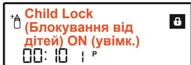
Щоб скасувати блокування від дітей, натисніть одночасно кнопки вибору «вгору» (7) та «вниз» (8) і утримуйте їх протягом 3 секунд. На дисплеї з'явиться повідомлення із зазначенням часу, протягом якого ще слід утримувати кнопки: «Keep Pressing..X» (Не відпускайте ... X). По закінченні цього часу буде скасовано блокування від дітей. На екрані з'явиться повідомлення «Child Lock OFF» (Блокування від дітей вимк.), і індикатор (17) згасне.
