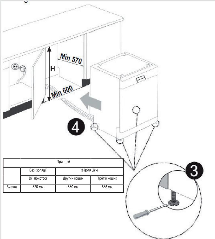
**Попередження:** після зняття стільниці машину можна розмістити у замкнутому місці, яке має розміри, зазначені на рис.
